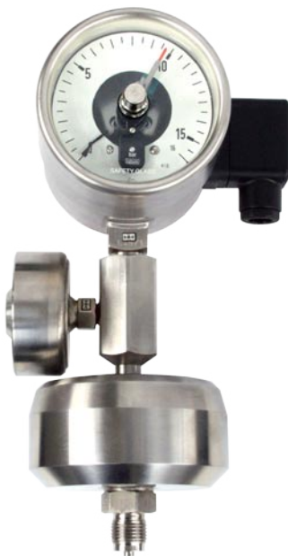
LABOMs Sonderdruckmittler mit Überdrucksicherung PN600 sowie Druckmessgerät mit Rohrfeder und elektrischem Grenzsinalgeber
